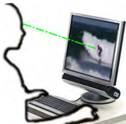
Figura 3.19: Esquema del seguidor ocular SMI EyeTracker. El sujeto se sitúa frente al monitor a una distancia de 60cm.
