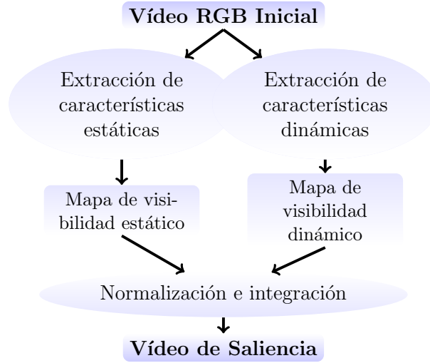
Figura 1.9: Esquema del modelo de Nabil Ouerhani. Este esquema realiza por una parte la extracción estática de características y por otra la extracción dinámica.
