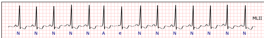
Figura 5.3: Fragmento de un ECG con latidos del tipo e y A entre latidos normales (N). (Fuente: MIT-BIH Arrhythmia Database, registro 223, entre 0:21:00 y 0:21:10)
