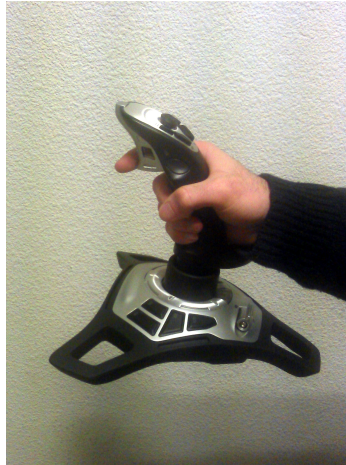
Figura 5.7: Joystick inalámbrico utilizado por el observador humano para proporcionar la señal de refuerzo al robot.
